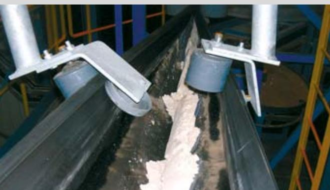
Transport protégé grâce à la structure fermée de la bande
